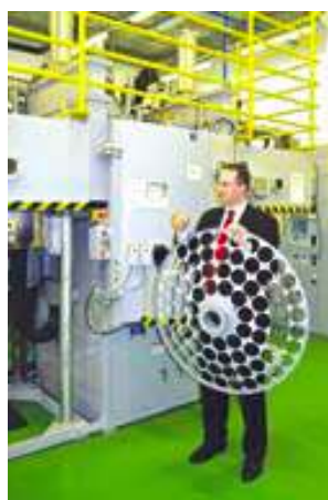
Najnowszej generacji maszyna CES do napyłniania powłok antyrefleksyjnych
