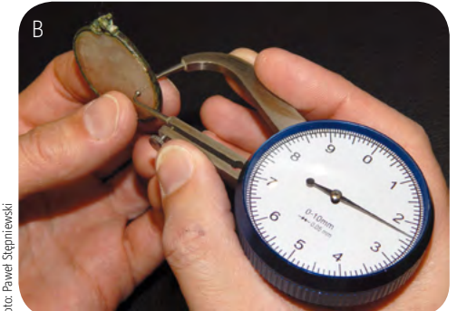
Fot. 5. Pomiar grubości soczewki zamontowanej w binoklach – pomiar grubości w centrum soczewki (A) oraz w części periferyjnej soczewki (B)
