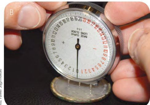
Fot. 6. Pomiar krzywizny wewnętrznej (A) i zewnętrznej (B) soczewki
