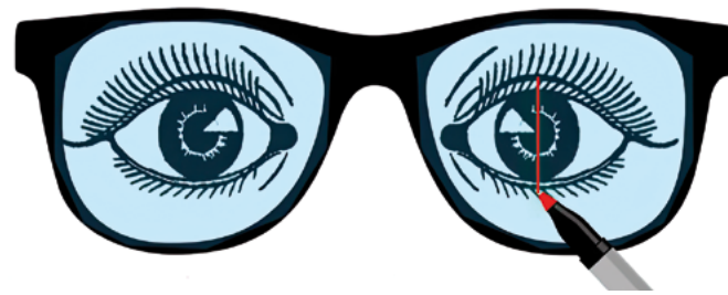
Ryc. 13. Zaznaczenie środka źrenicy na demolensie oprawy okularowej
