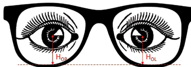
Ryc. 14. Wysokości montażowe określone względem dolnej krawędzi soczewki
