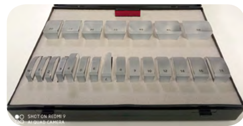
Fot. 2. Zestaw pryzmatów półokrągłych do diagnostyki leczenia zeza Źródło: archiwum Magdaleny Zarębskiej-Lindner
