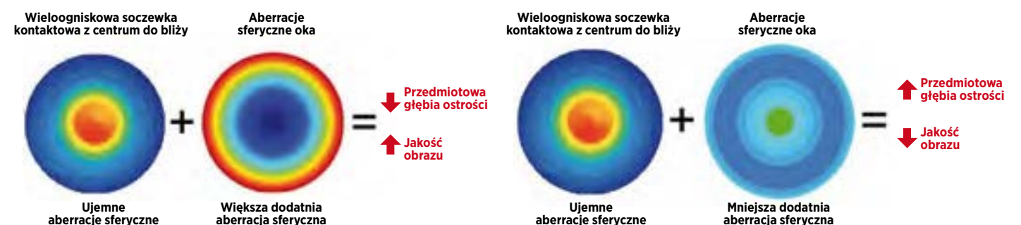
Ryc. 6. Profile mocy obrazujące, jaki „efekt na oku” daje soczewka wieloogniskowa z centrum do blizy, dla oka o mniejszej (po prawej) oraz większej (po lewej) aberracji sferycznej oraz ich wpływ na przedmiotową głębię ostrości i ostrość wzroku
