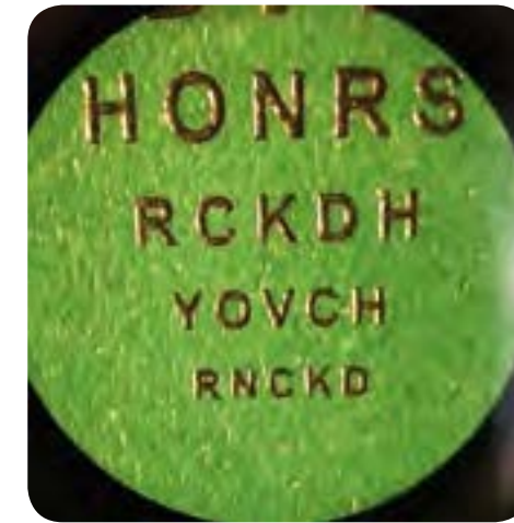
Fot. 5 i 6. Fotografia zrobiona przez okular lampy szczelinowej pokazuje zastosowanie dwóch wielkości powiększeń (fot. 5 – 16x i fot. 6 – 25x) przy obserwacji przesłonki do badania wzroku. Zastosowanie znanej specjalistom przesłonki pozwala na łatwiejsze wyobrażenie sobie wielkości powiększenia. Warto też zauważyć wrażenie przybliżenia obrazu przy zastosowaniu większego powiększenia.
