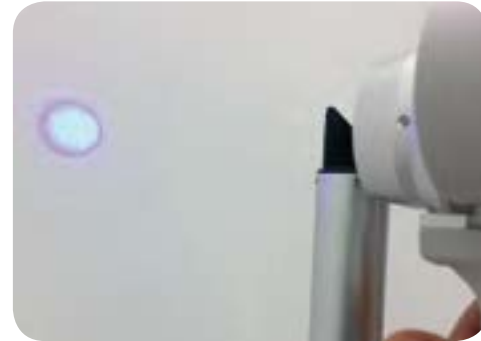
Fot. 3 i 4. Ustawienie szerokości szczeliny – zdjęcie pokazuje jedno z wielu możliwych (szerokość jest zmieniana w sposób płynny) sposobów ustawienia szerokości szczeliny w ręcznej lampie szczelinowej i wyświetlenia przez nią światła z filtrem kobaltowym na płaskiej powierzchni. Szczelina wąska (fot. 3) i szeroka – otwarcie źródła światła (fot. 4).
