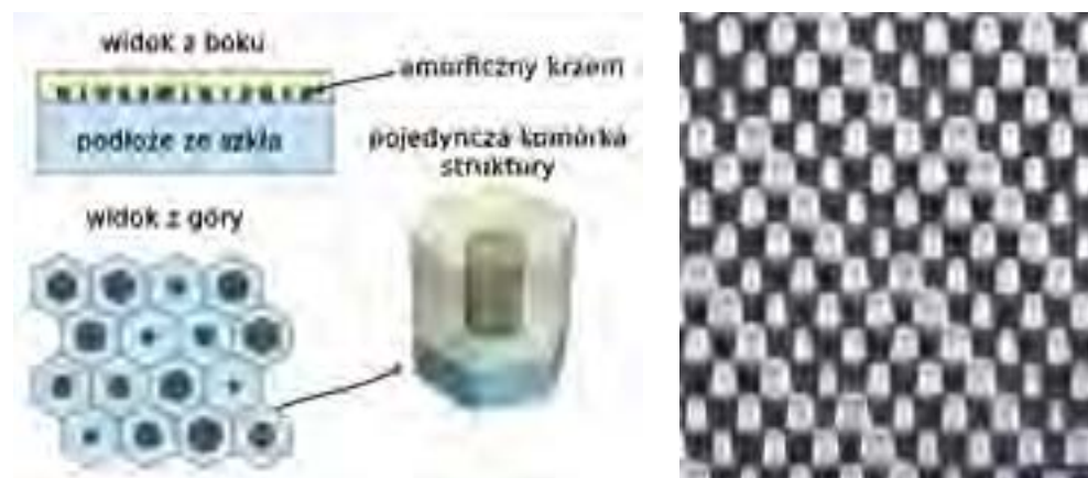
Ryc. 5. Schemat konstrukcji metapowierzchni po lewej oraz zdjęcie wykonane mikroskopem elektronowym po prawej (fioletowy znacznik skali ma 1 μm) [10]
