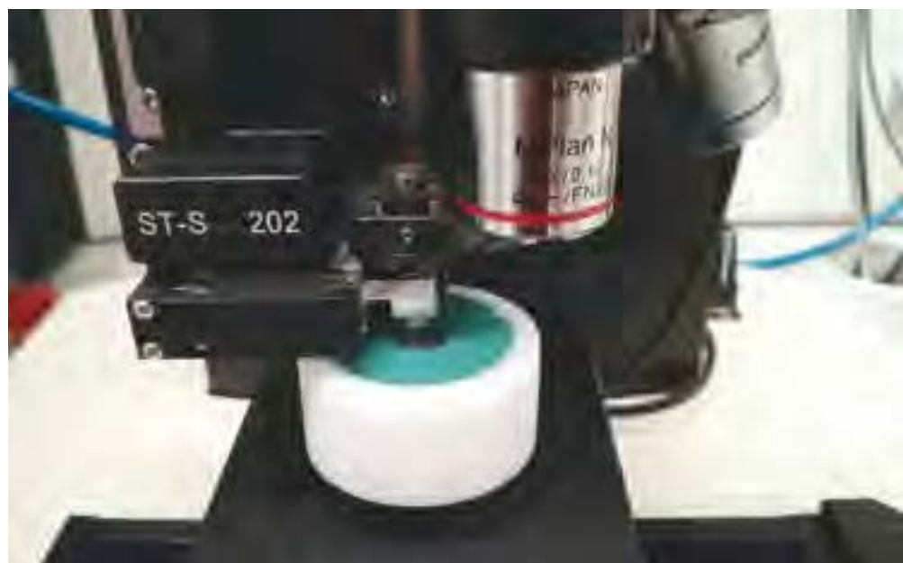
Rycina 1. Mikrotrybometr wykorzystany do pomiaru tarcia i odległości, stanowiących podstawę obliczeń energii związanej z tarcieniem. Powierzchnia pomocnicza pokryta mucyną jest przesuwana po powierzchni soczewki kontaktowej poddanej działaniu płynu o właściwościach podobnych do filmu łzowego (TFL). Siła i prędkość symuluje ruch powieki. Zdjęcie dzięki uprzejmości SuSoS, AG.
