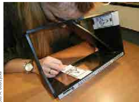
Fot. 9. Stereoskop zwierciadlany pojedynczy ukośny
