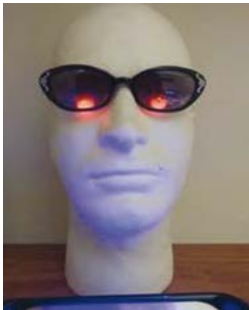
Ilustracja 2. Po lewej: fluorescencja farby czułej na promienie UV, umieszczonej w miejscu oczu, wskazuje na znaczne oddziaływanie promieniowania UV, nawet pomimo noszenia okularów przeciwsłonecznych. Po prawej: Okulary przeciwsłoneczne o dużej krzywiznie oprawy, dopasowane do kształtu twarzy, zapewniają większą stopień ochrony przed promieniowaniem UV.
