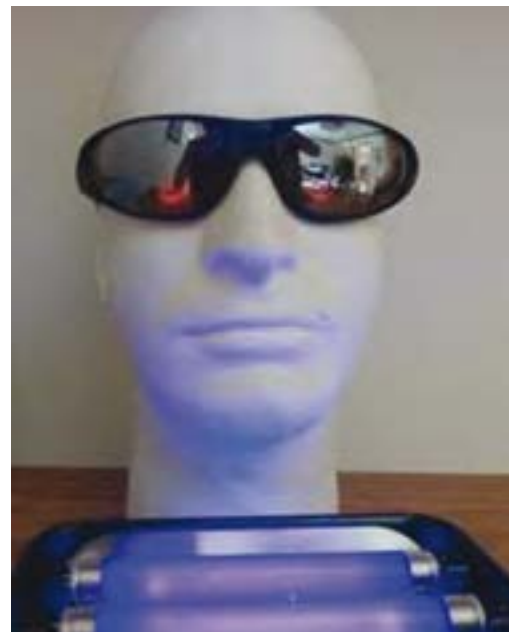
Ilustracja 2. Po lewej: fluorescencja farby czułej na promienie UV, umieszczonej w miejscu oczu, wskazuje na znaczne oddziaływanie promieniowania UV, nawet pomimo noszenia okularów przeciwsłonecznych. Po prawej: Okulary przeciwsłoneczne o dużej krzywiznie oprawy, dopasowane do kształtu twarzy, zapewniają większą stopień ochrony przed promieniowaniem UV.
