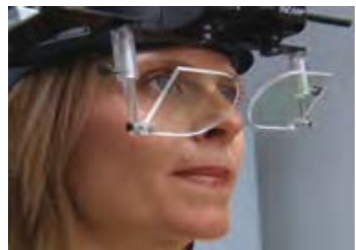
Rycina 3. Ocena właściwości użytkowych miękkich, torycznych soczewek kontaktowych za pomocą symulacji rzeczywistych warunków użytkowania z użyciem systemu do śledzenia ruchów oczu (EyeTrack Monitoring System).
