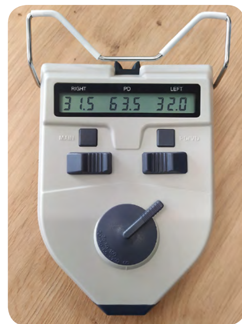
Ryc. 1. Pupilometr z wartościami PD do dali dla oka prawego (31,5 mm) i lewego (32 mm)
