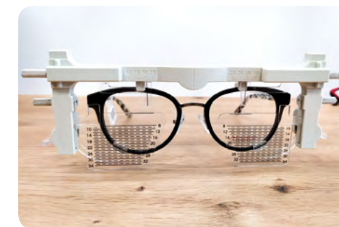
Ryc. 2. Nakładka do pomiaru wysokości montażowej
