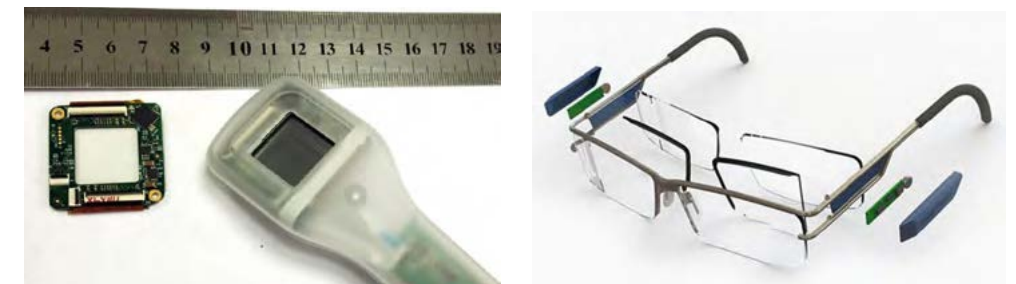
Ryc. 3. Z lewej działający prototyp warstwy ciekłych kryształów, która może zmieniać współczynnik załamania, z prawej wizualizacja koncepcji okularów. Źródło: www.deepoptics.com
