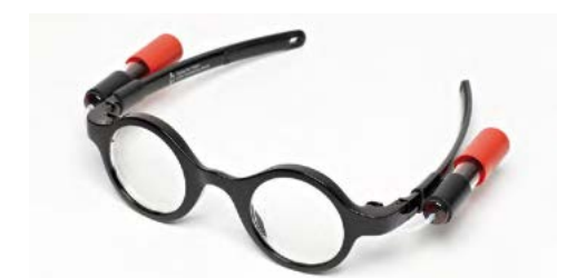
Ryc. 2. Okulary o mocy regulowanej za pomocą wtlaczania płynu do środka soczewki, wykonanej z tworzywa sztucznego. Po ustaleniu mocy można odłączyć adaptery, uzyskując stałą moc, bądź regulować w miarę potrzeby. Źródło: www.woxford.org/childvision/
