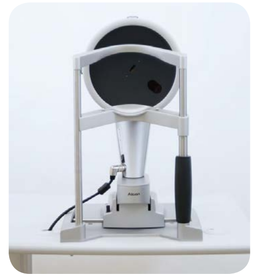
Fot. 5. Oculyzer II – topograf rogówkowy z kamerą Scheimpfluga
